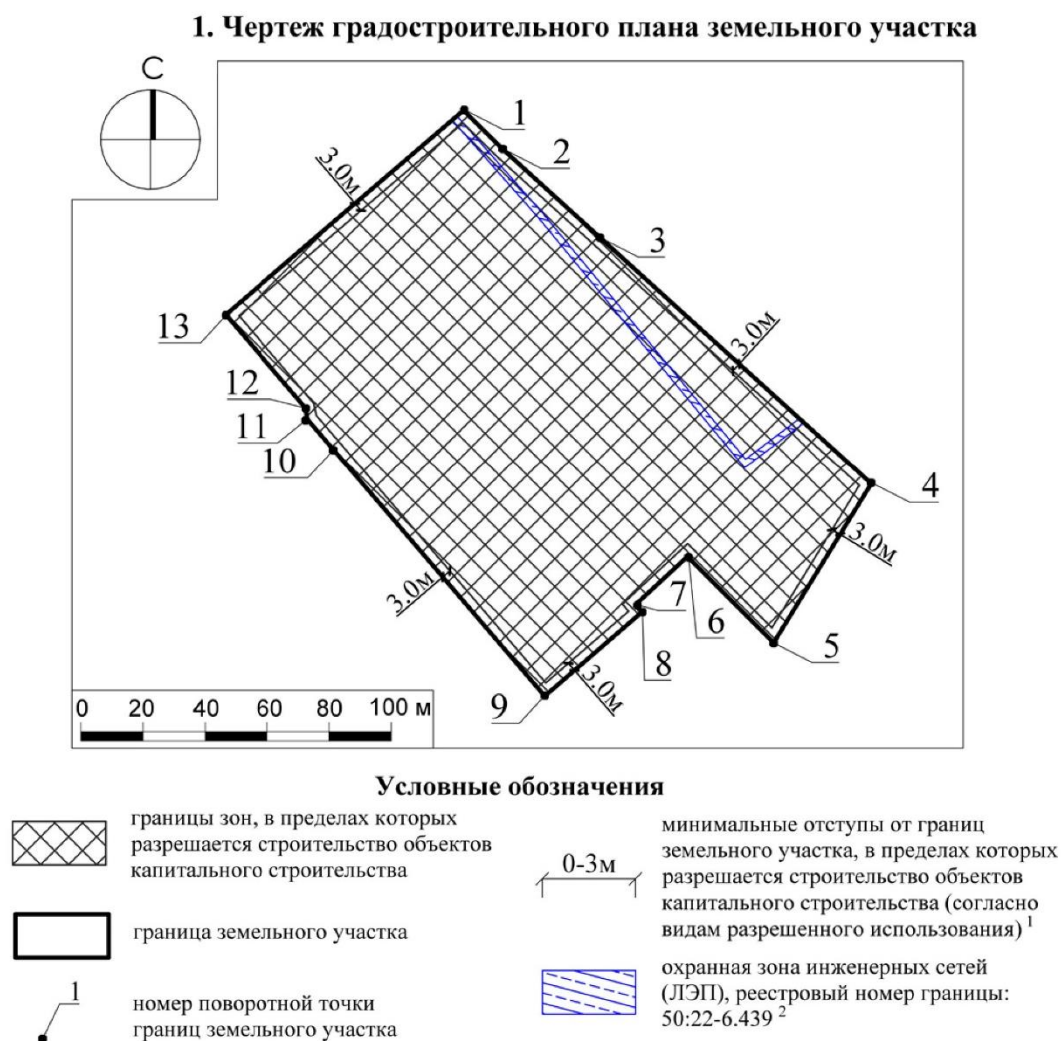
Рисунок 2 – Чертеж градостроительного плана земельного участка
