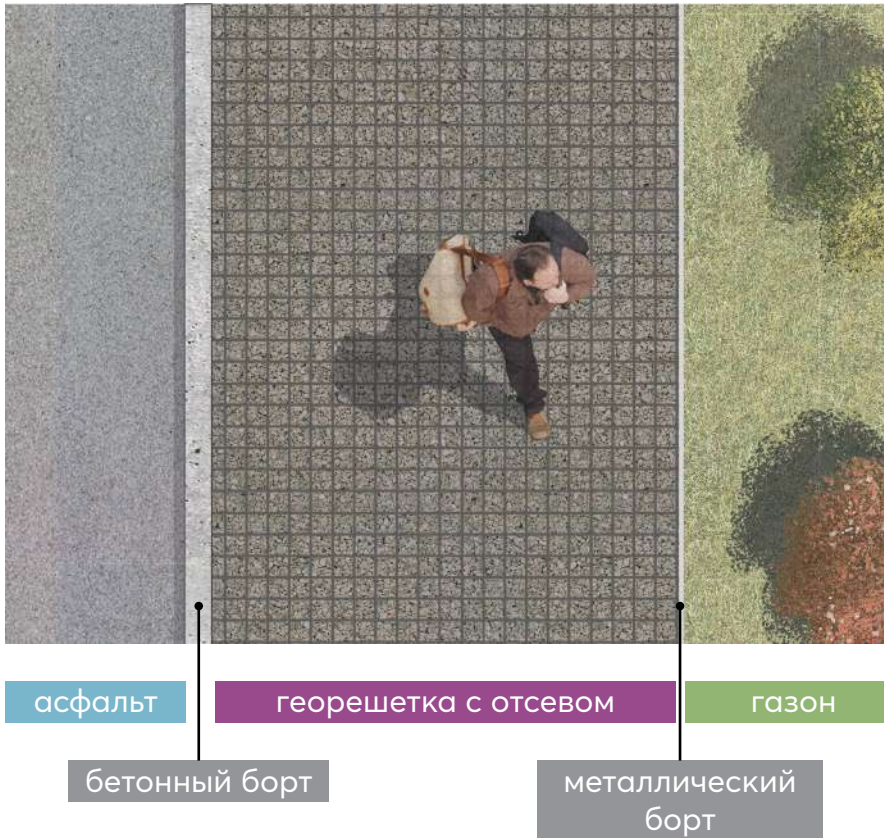
Сопряжение георешетки и стабилизированного отсева с настилом из ДПК и газоном
