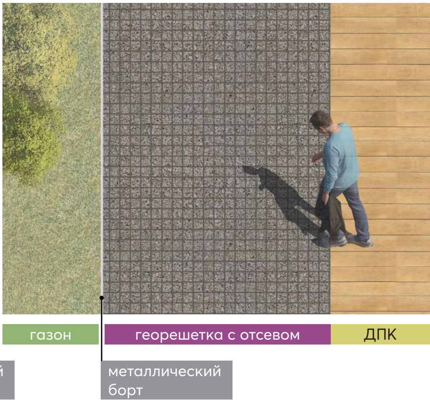
Сопряжение георешетки и стабилизированного отсева с настилом из ДПК и газоном
