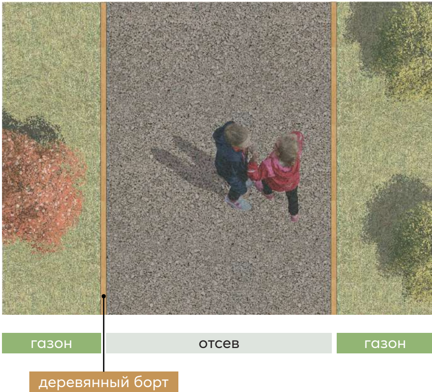
Сопряжение георешетки и стабилизированного отсева с гранитным отсевом и газоном
